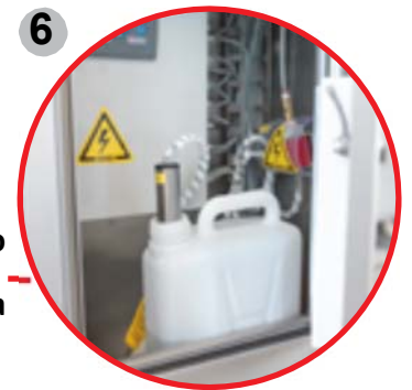
6 Contenedor de almacenamiento químico cerrado dentro la máquina
