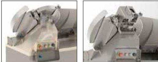
La protección de la cuchilla incorpora un sensor de seguridad. La máquina no se enciende si la tapa no está puesta. También hay un sensor de seguridad incorporado en la protección de la unidad de afilado. Se coloca un botón de parada de emergencia adicional cerca de la cuchilla para prevenir riesgos.
